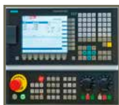
Controlador Siemens 808D
